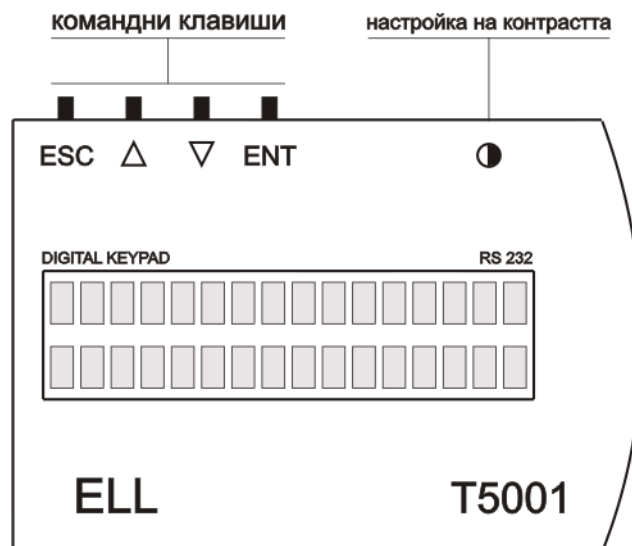
Рисунок 6-1 Терминал для настройки T5001
